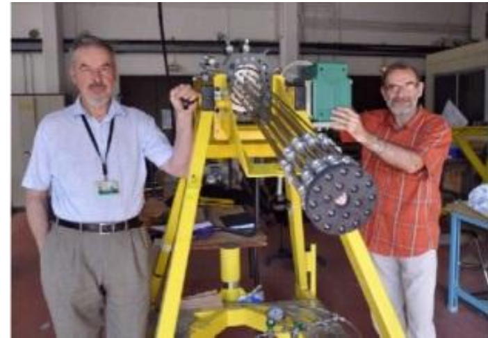
Sergei Putvinski (à gauche) et le physicien de la fusion François Saint-Laurent (IRFM) ne manipulent pas une mitrailleuse Gatling. Ils sont devant un prototype de système d'atténuation des disruptions. Ce système de canon à cartouche effectuera ses premiers tests dans Tore Supra*. *ITER Newslines #176, Mai 2011
