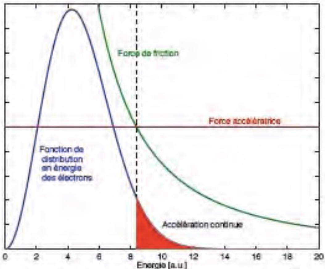
Figure 2.21 – Accélération d'électrons suivant une distribution d'énergie maxwellienne
