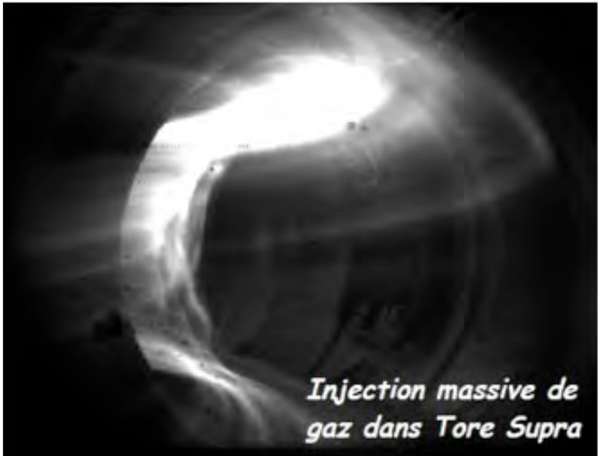
il a été démontré que plus le gaz injecté est léger (hélium), plus il pénètre rapidement dans le plasma et meilleure est la suppression des électrons énergétiques créés pendant la disruption elle-même ce qui est l'un des buts recherchés.
