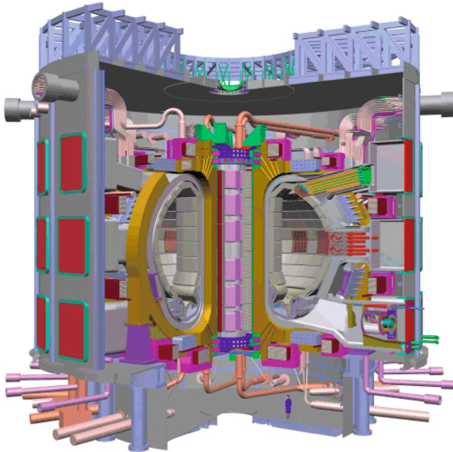
Figure 1.14 – Schéma en coupe d'ITER (Source : ITER Organization)
