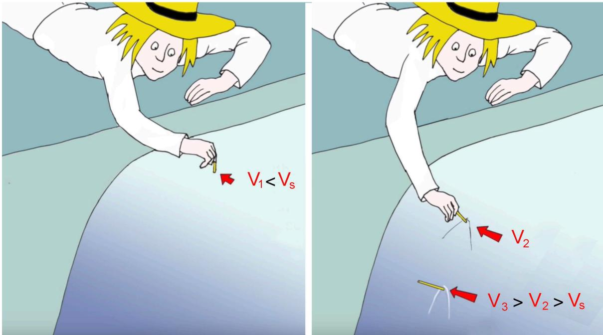
*A gauche la vitesse  $V$  de l'eau est inférieure à  $V_s$ , celle des ondes de surface : pas de vaguelettes. A droite cette vitesse est dépassée. Quand elle s'accroît les ondes se couchent de plus en plus.*
