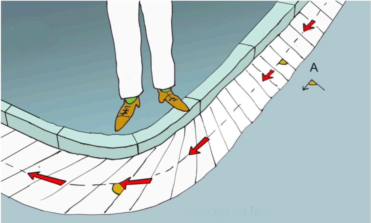
Autre configuration, voir ci-dessous. La vitesse décroît alors. Les ondelettes s'accroissent alors et un ressaut apparaît, où la hauteur d'eau s'accroît brusquement en où la vitesse de l'eau diminue. C'est l'analogie fidèle d'une onde de choc.
