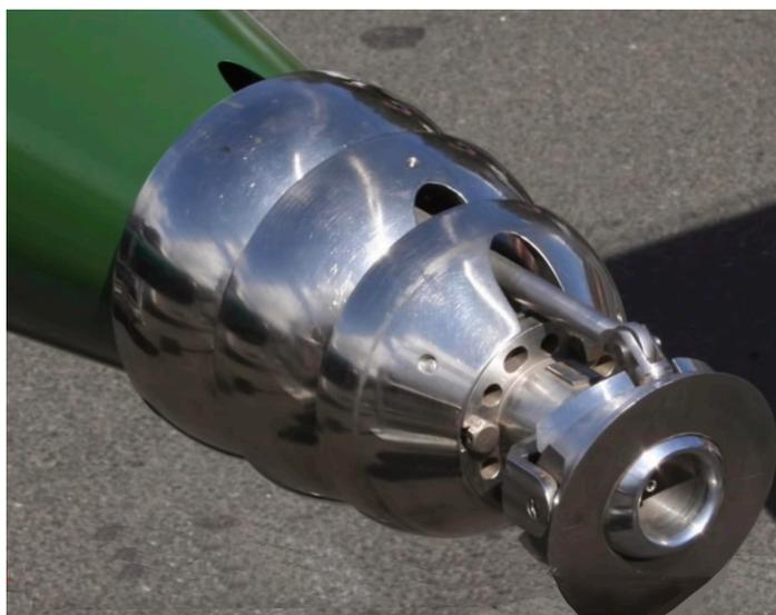
La buse de sortie des gaz de combustion, orientable grâce à de simples vérins. Ce système permet de moduler le flux de gaz injecté d'un côté ou de l'autre de la torpille. Cela crée une friction différentielle sur des parois opposées et représente donc un moyen extrêmement efficace de piloter l'engin fondamentalement différent des classiques ailerons, ou du système de tuyère orientable.
