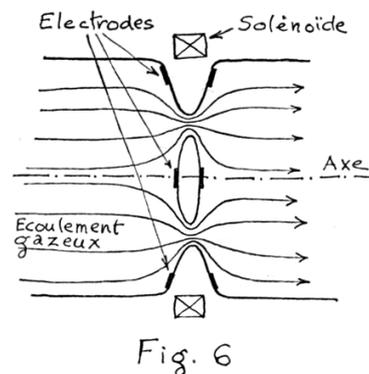
mise en vitesse. Col à variation rapide de section, donnant une mise en vitesse et une détente brutales (accompagnées d'un figeage). Les forces de Lorentz assureraient un passage sans décollement du gaz à travers l'orifice.
