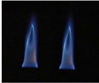
Une flamme alimentée avec de l'oxygène excité (à droite) produit moins de suie (visualisée par la fluorescence rosée) qu'une flamme alimentée par de l'oxygène non excité (à gauche).
