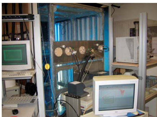
À gauche, vue d'ensemble de la chambre de simulation atmosphérique (d'un volume de 8 m 3 ) ; à droite, réacteur à écoulement et spectromètre de masse ; © ICARE-CNRS.
