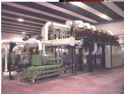
MARHy et son environnement expérimental ; le groupe de pompage ; jeu de tuyères utilisées dans le moyen d'essais MARHy ; © ICARE-CNRS.
