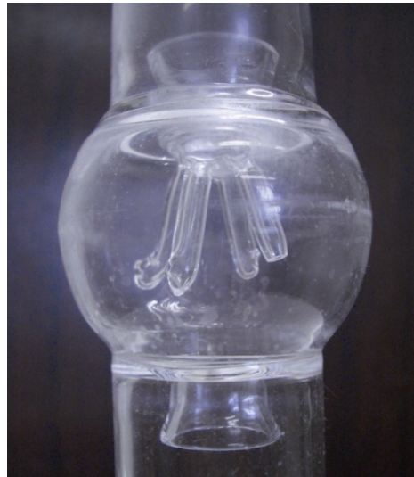
Réacteur auto-agité par jets gazeux, en silice fondue, utilisé pour mener les études expérimentales sur la cinétique chimique de la combustion © ICARE-CNRS.
