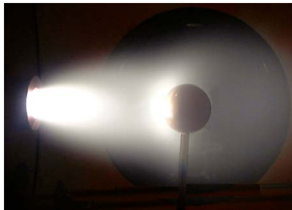
À gauche, vue d'artiste de l'orbiteur Mars Explorer ; à droite, Interaction entre un jet supersonique de plasma obtenu à partir d'un mélange CO 2 -N 2 et une sphère métallique ; © ICARE-CNRS.
