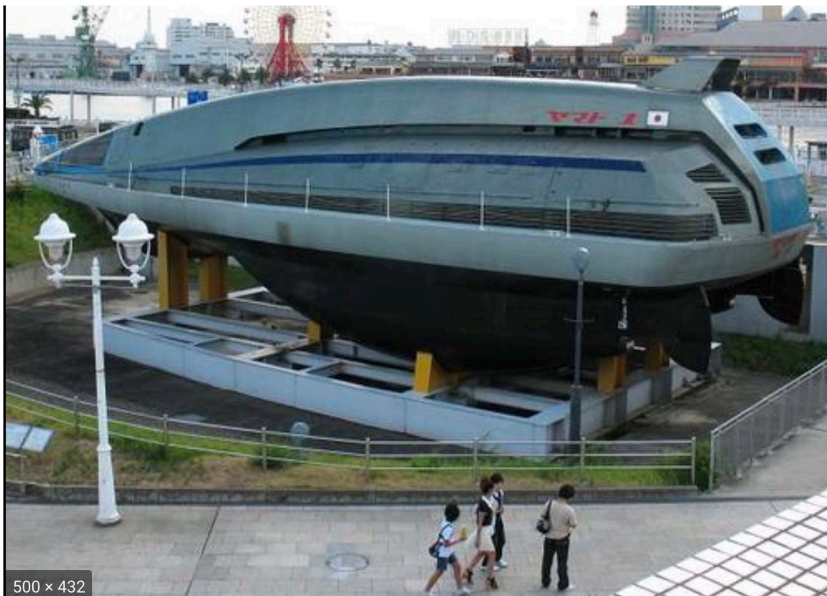
Le Yamato 1 au musée de Kobe. 30 mètres de long, 14 mètres de large, 280 tonnes ! Ses propulseurs, crachant 2000 ampères lui donnaient une poussée de 1,6 tonne.
