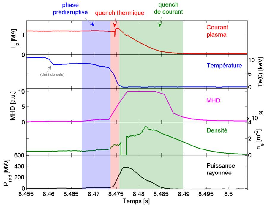
**Figure 2.1** – Déroulement d'une disruption. (a) courant plasma (b) Température électronique (c) Activité MHD (d) Puissance rayonnée (e) densité électronique linéique. Note : la première chute de la température n'est pas liée à la disruption.
