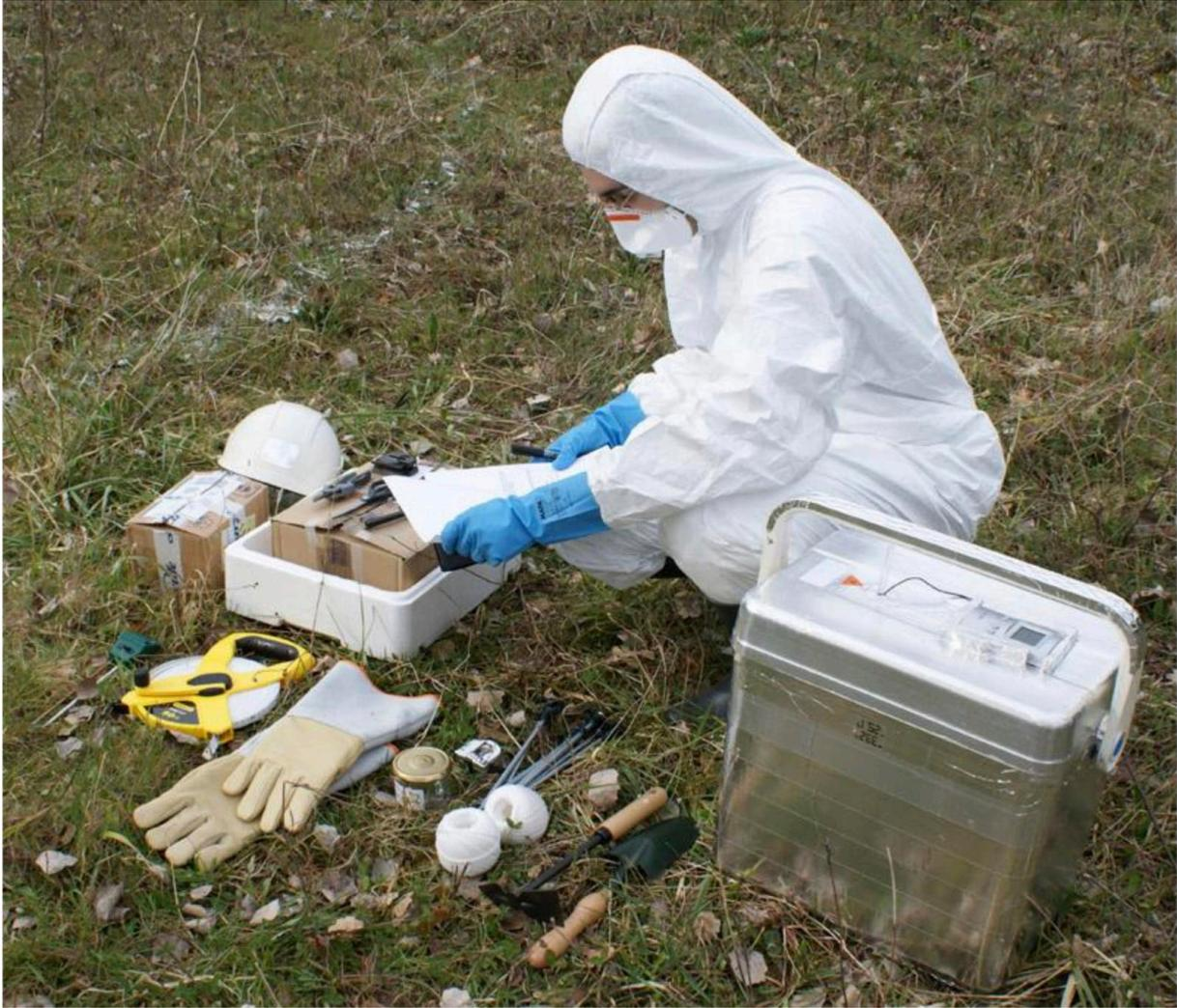
**Le matériel complet pour le prélèvement d'échantillons végétaux sur trace**
