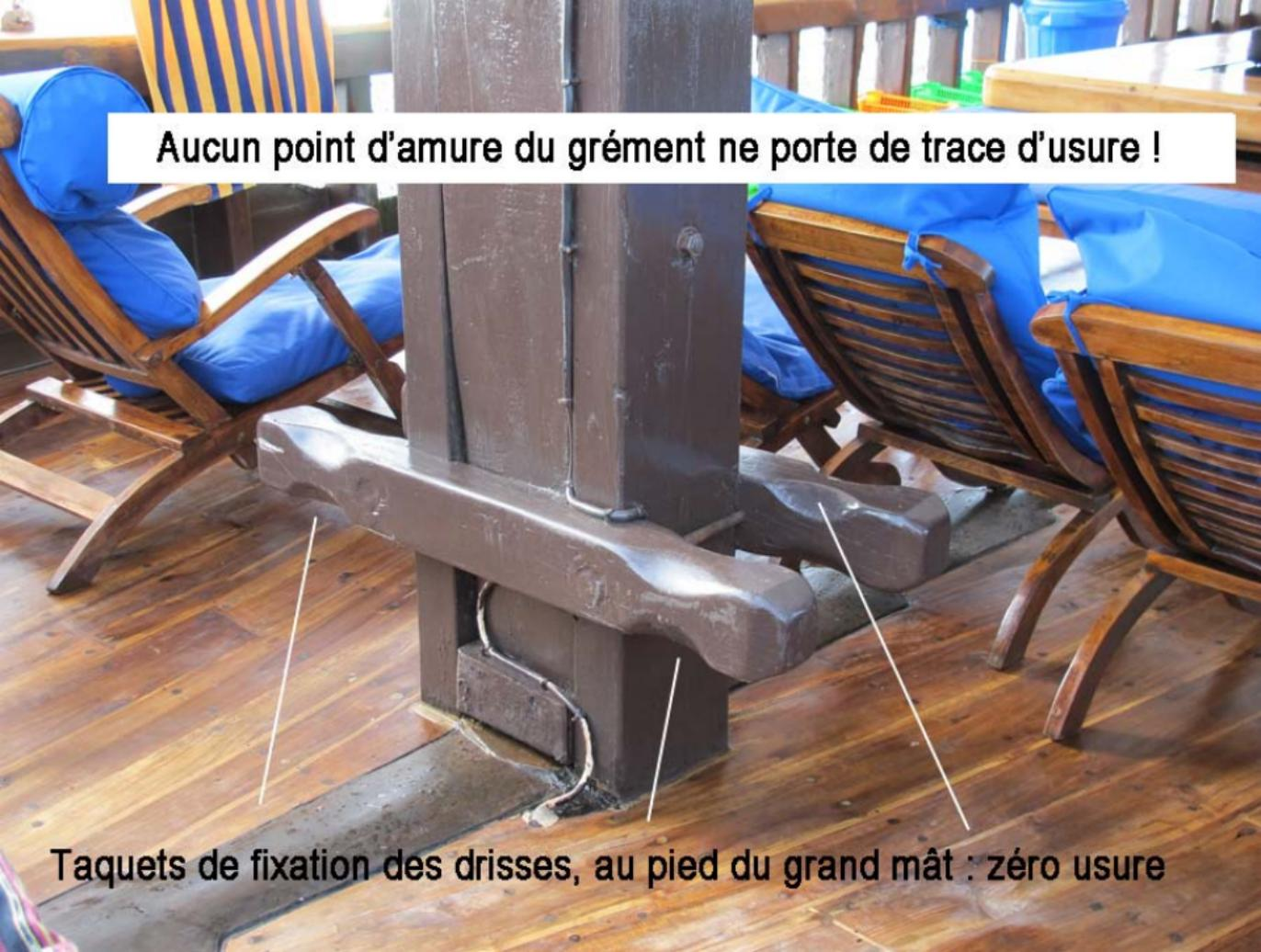
**Taquets de fixation des drisses, au pied du grand mât : zéro usure**
